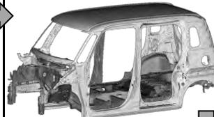
U/B ASSY、S/M ASSY、ROOF ASSYを組み合わせ、車両本体のM/B ASSYを形成
