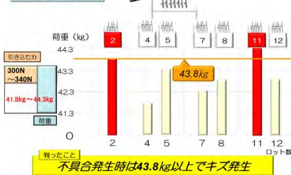
340Nの引く力が発生したロットの荷重調査をした結果41.8kg~44.3kgの間を推移していましたがキズの発生した2ロット目と11ロット目のみが43.8kg以上となっていることがわかりました。
