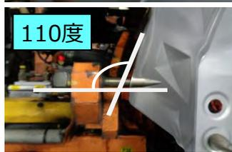
上側はロケットピンに対してバックピラーが90度と垂直になっているが、下側は110度とバックピラーが斜めになっている。
