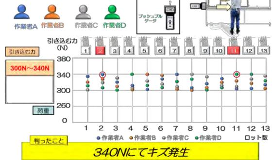
作業員4名の引く力を計測したところ300N~340Nと40Nのバラつきがあり、作業員A 2ロット目と作業員D 11ロット目どちらも最大の340Nにてキズが発生した為340Nの引く力が発生したロットを対象を絞り込み荷重の調査を行いました。
