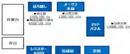
上記段取りを合計して3hの自段取時間が発生している
