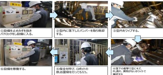
落下が発生すると、1回につき12分の設備停止が発生し生産ロスとなります。型内に落下したバンパーを取りに行き廃却、型内を異常がないかライトで確認してロボットを原点復帰、そして設備を再稼働します。落下発生時はこの一連の作業を行います。また、12分で10本生産でき落下が発生することで生産が遅れます。
