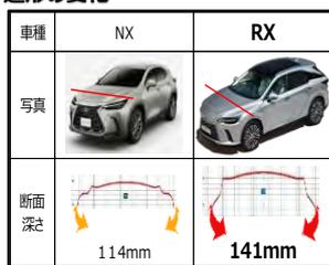
パネルサイズが大型化し、より深く巻き込むデザインへ変化
